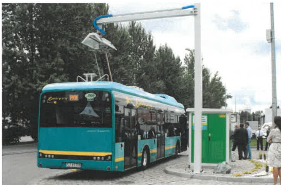
Rysunek 4 Pantografowa stacja ładowania autobusów elektrycznych w Jaworznie, źródło: https://www.transport-publiczny.pl/img/jaworznostacja1.jpg_678-443.jpg
